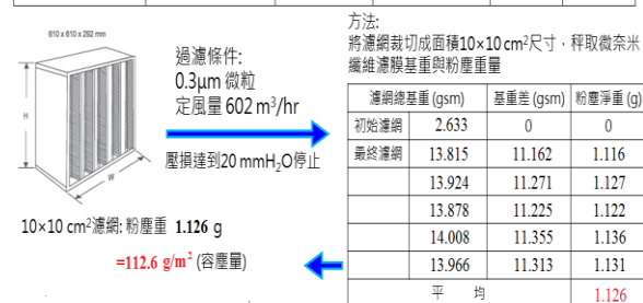
圖 5 熔噴/靜電紡絲複合纖維濾材容塵量分析
